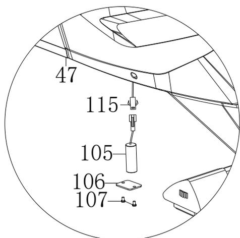
Открутите болты (107), и снимите кожух отсека аккумулятора (106) с помощью гаечного ключа (B). Извлеките аккумулятор (105), разъедините аккумулятор и магистральный кабель (115), подсоедините новый кабель аккумулятора и вставьте дополнительный кабель в нижнюю часть корпуса основной рамы (47), затем, вставьте болты (107) и кожух отсека аккумулятора (106) с помощью гаечного ключа (B).
