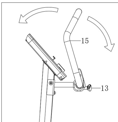
Разблокируйте регулировочную ручку (13), затем отрегулируйте угол наклона руля (15) в нужное положение в соответствии с рисунком.
